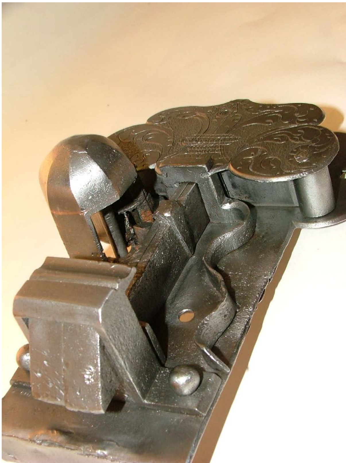
Obr. 31. Detail - uchycení fixačním raménkem úchytného třmenu závor po restaurování a konzervaci.
