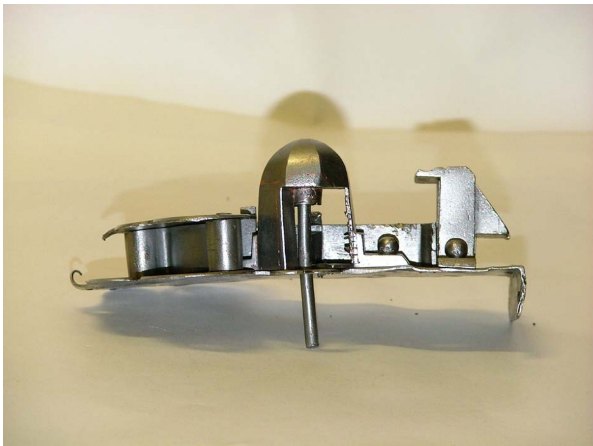
Obr. 29. Boční pohled na zámek – spodní. Zachování středového vyosení vodícího mechanismu klíče. Zachování vrcholů podložního plechu a ozdobné destičky (vlevo).
