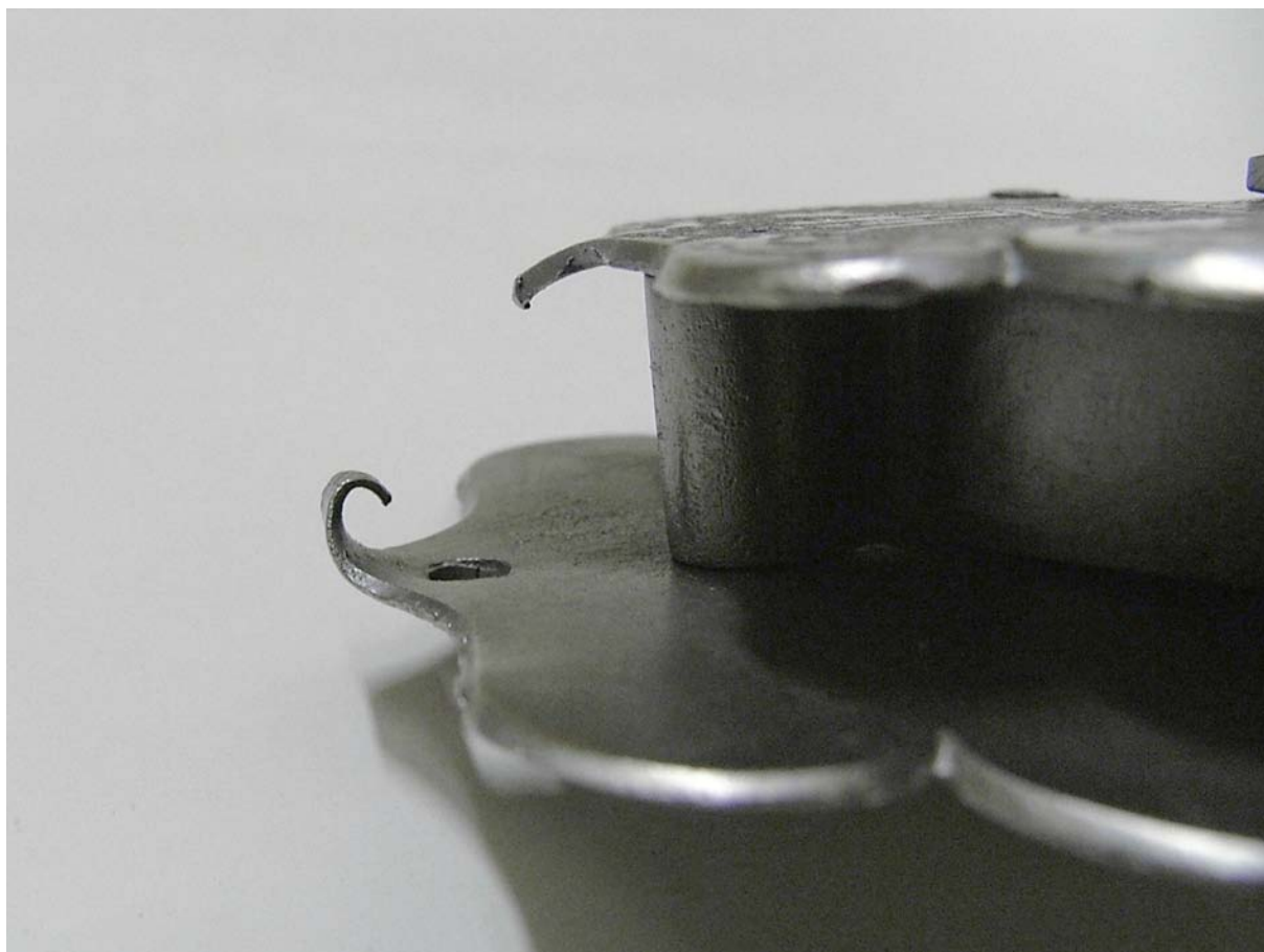
Obr. 34. Detail ohnutí na podložním plechu a ozdobné destičce po restaurování a konzervaci.
