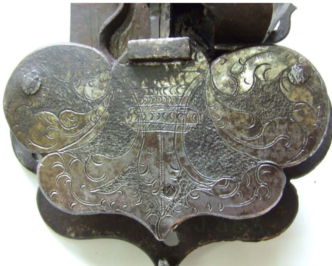
Obr. 18. Pozvolné odstraňování korozních produktů - ozdobná destička. Při odstraňování korozních produktů se neprokázaly zdobné techniky (taušírování, cínování).
