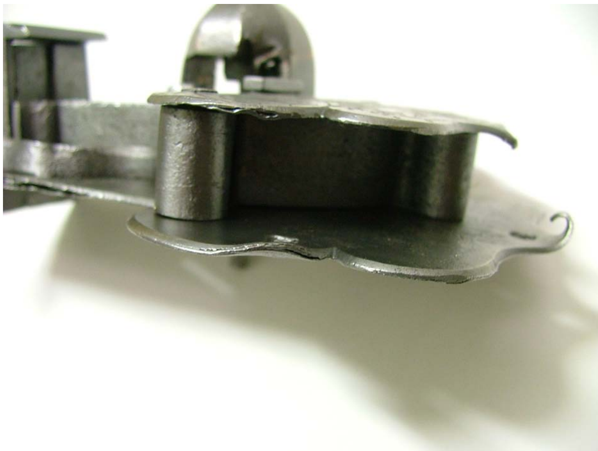
Obr. 39. Deformace podložního plechu. Tyto deformace vznikly neodborným sejmutím dveřního zámku z dveří.
