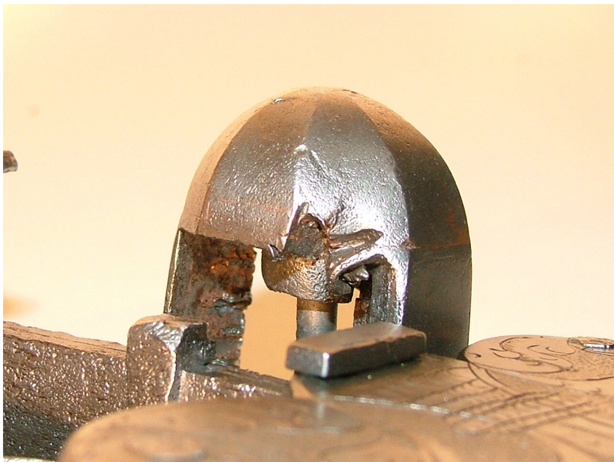
Obr. 35. Detail - kupolovitá hraněná aplika – deformace násilného vniknutí do zámku po restaurování a konzervaci.
