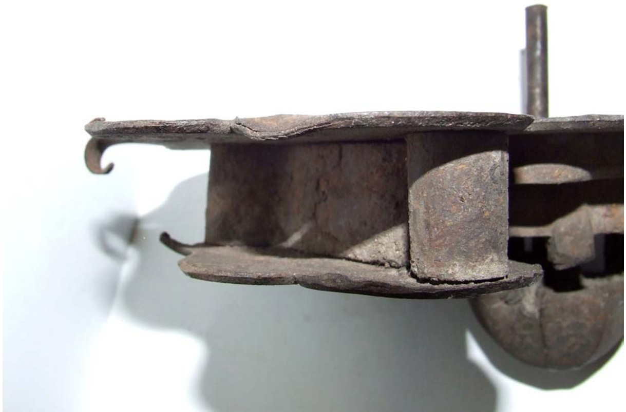
Obr. 11. Deformace spodního podložního plechu. Deformace horního ozdobného plechu.
