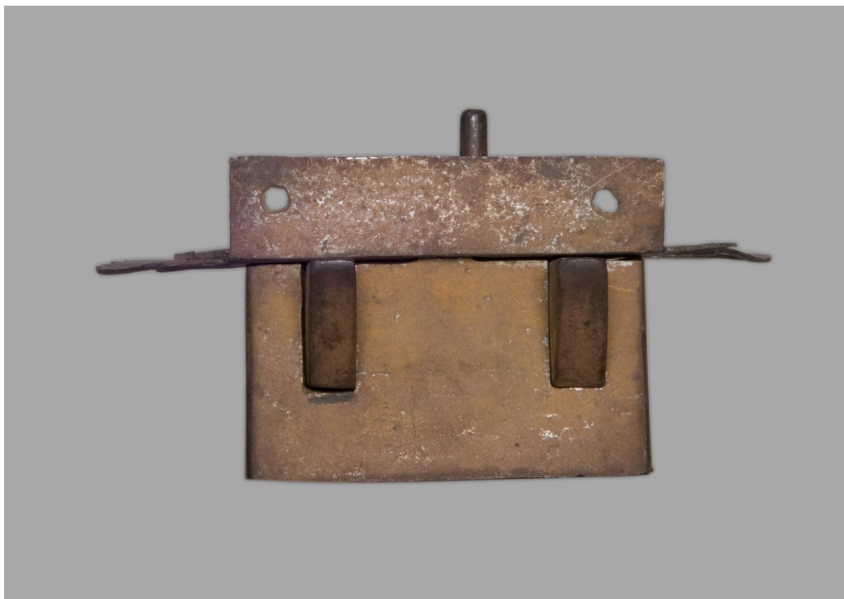
Obr. 4. Čelní pohledová strana nábytkového zámku. Podložní plech – čelní zahnutí se dvěma montážními otvory. Obdélná kazeta s otvory pro dvě závory. Celoplošné pokrytí prachovými částicemi a korozními produkty na celém nábytkovém zámku.
