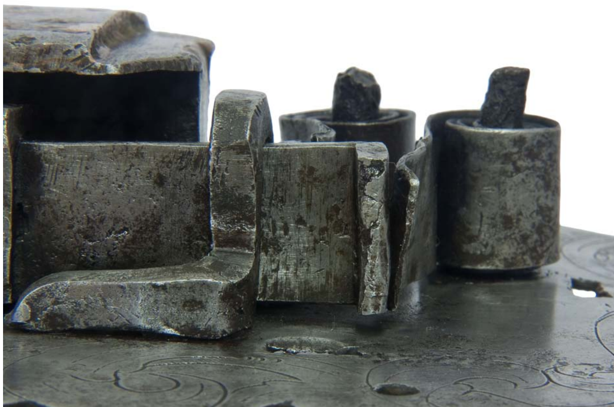
Obr. 41. Detail - uchycení fixačního raménka úchytného třmenu závor po restaurování a konzervaci.
