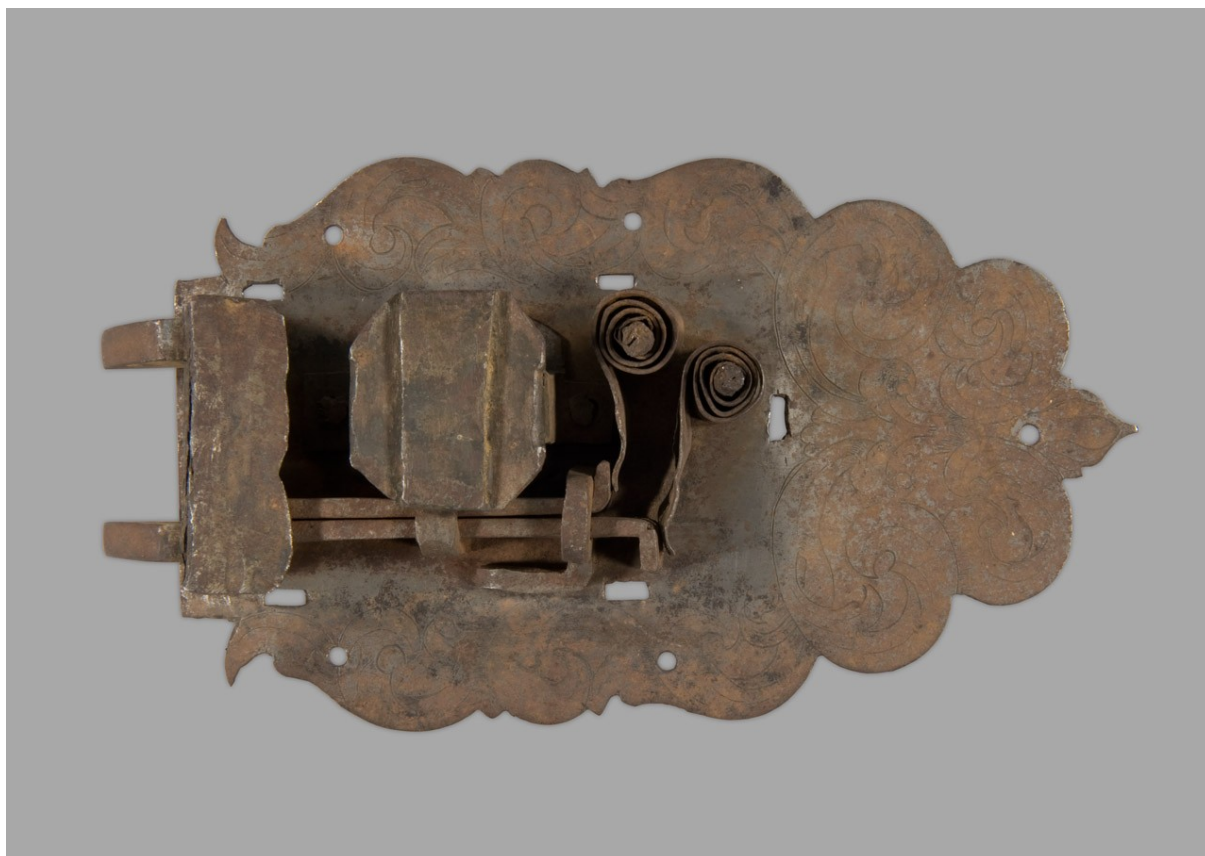
Obr. 5. Čelní pohled na nábytkový zámek. Zámkový mechanismus nábytkového zámku. V podložním plechu otvory pro úchyty obdélné kazety. Znatelné prachové částice (v místech s větším usazováním prachových částic jsou korozní produkty intenzivnější). Korozní produkty v celé ploše nábytkového zámku.
