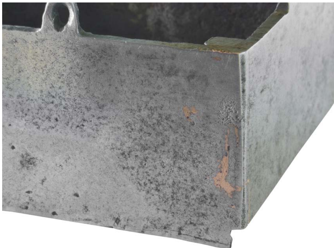
Obr. 30. Detail - odstraňování korozních produktů z podložního plechu. Vnější pohled na rám, kde je rám spojen spojovací technologií tvrdého pájení mědi. V ploše rámu je patrná důlková koroze.
