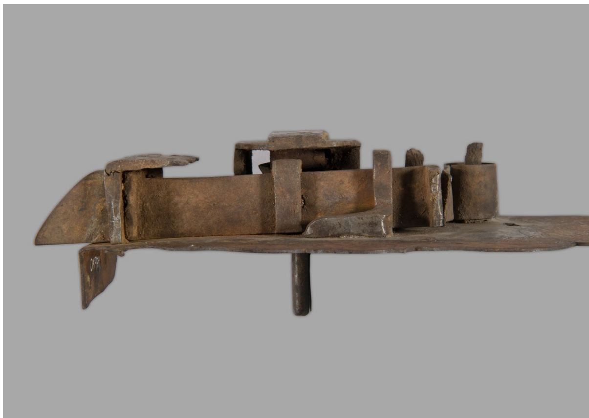
Obr. 6. Boční pohled na nábytkový zámek – levý. Znatelné prachové částice, korozní produkty. Uchycení závor fixačním raménkem úchytného třmenu závor. Čelní L-profil závor je v ohnutí prasklý.
