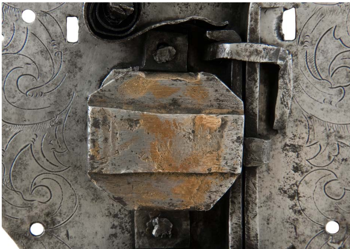
Obr. 36. Detail – hraněná aplika s technologií tvrdého pájení mědi. Stabilizování roztokem tanátu A a následná konzervace minerálním olejem WD 40 s včelím voskem.
