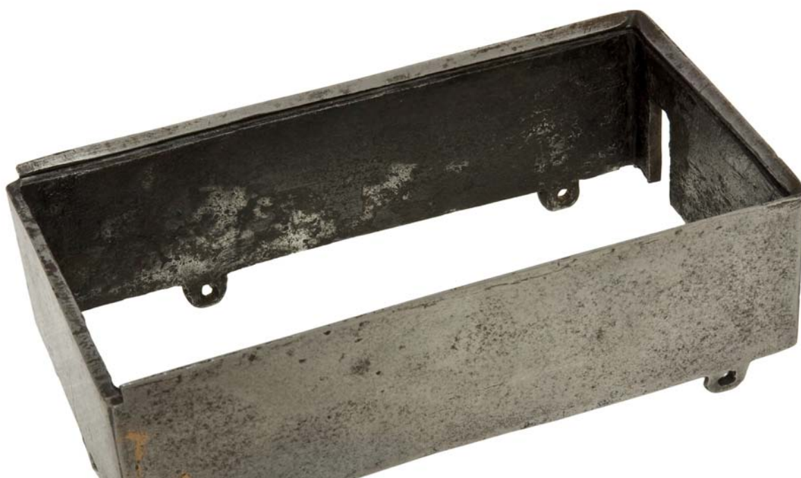
Obr. 49. Na vnitřní straně rámu obdélné kazety jsou zbytky okují vzniklé kovářskou výrobou. Vnitřní prostory jsou stabilní, zakonzervované minerálním olejem WD 40 s včelím voskem.
