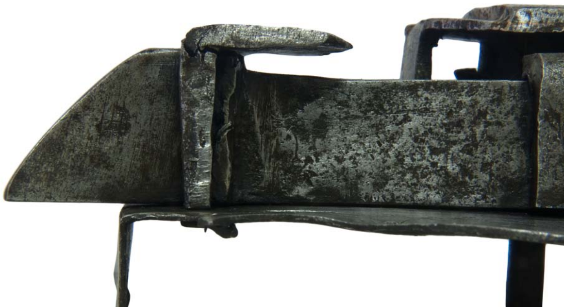
Obr. 40. Prasklina v čelním L- profilu závor je materiálová vada vzniklá výrobou. Tato prasklina nemá vliv na pevnost nábytkového zámku. Na závoře jsou viditelné rýhy od pilování (zámečnické práce).
