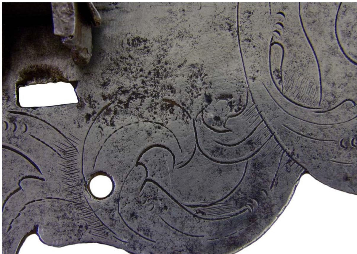
Obr. 25. Detail - dekor akantových rozvilin. Linie dekoru je zvýrazněná pozvolným přechodem rýh od jemných po výrazné. Znatelná důlková koroze. Pozvolné odstraňování korozních produktů. V ploše podložního jsou viditelné rýhy po pilování.
