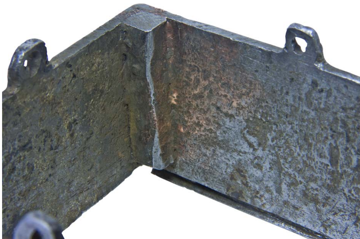
Obr. 29. Detail - odstraňování korozních produktů.
