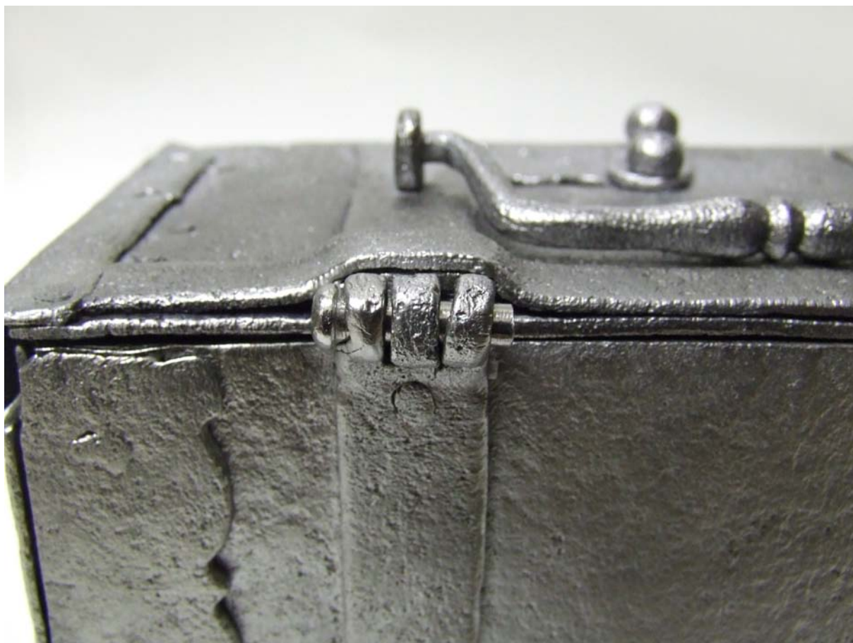
Obr. 51. Detail - Reverzibilní čep – pravý - na dílu A a dílu B.
