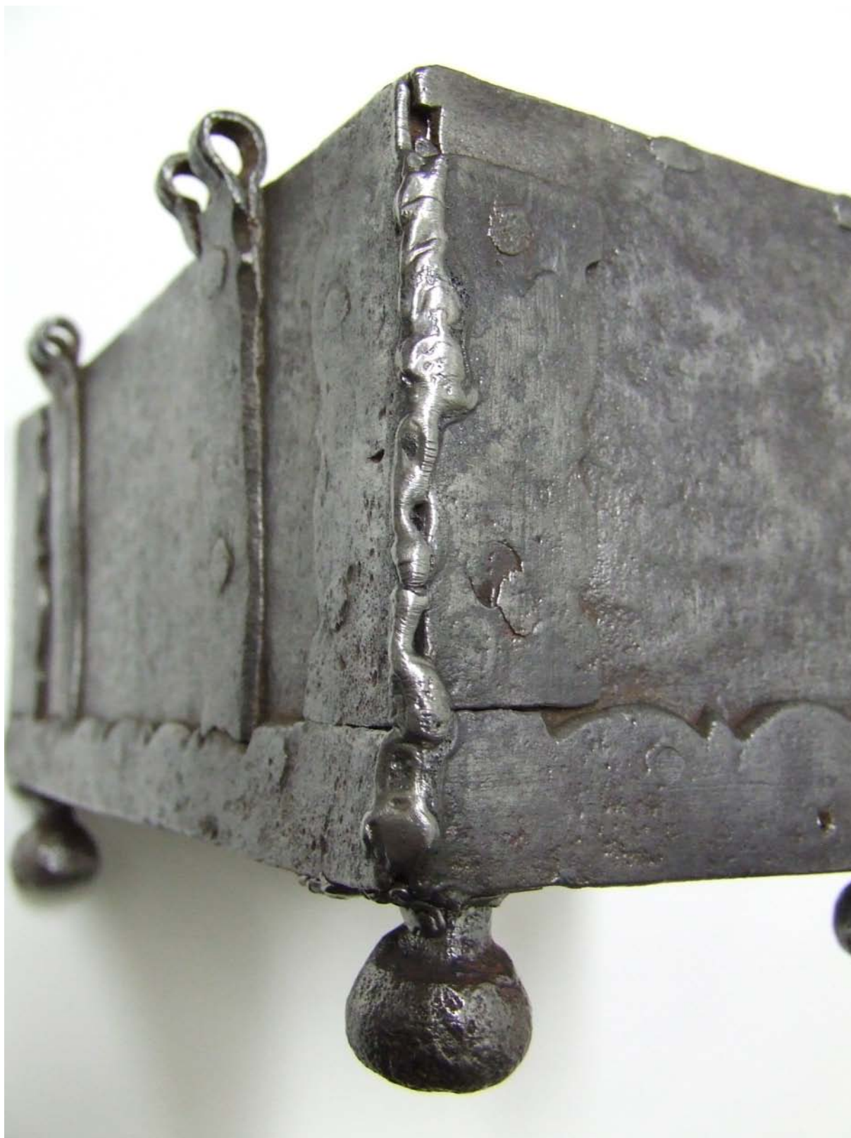
Obr. 40. Detail - vnější rohový svár na zadním plechu a pravém bokem. - svár je očištěn od zbytků strusky , je nesouměrný a přerušovaný - na cibulovité nožičce je viditelné kovářské zpracování
