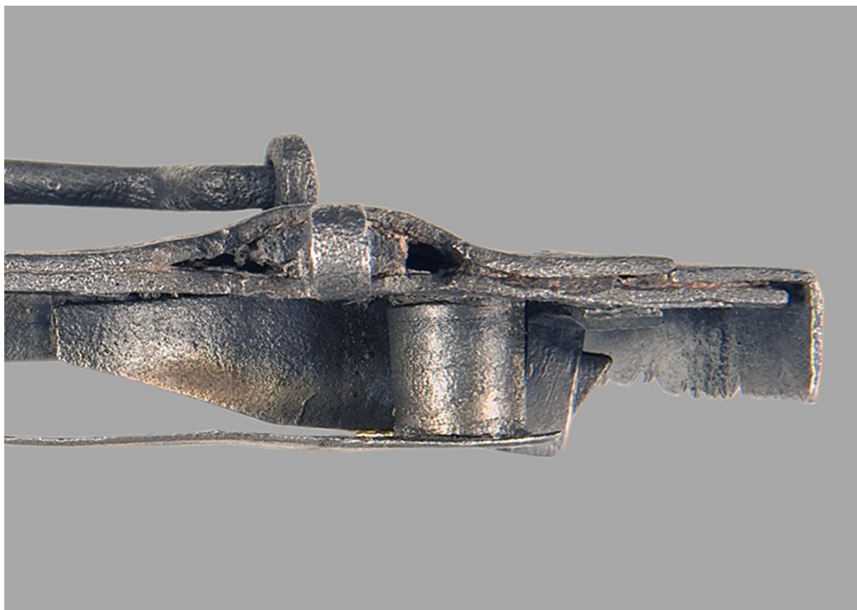
Obr. 12. Pružiny - znatelné znečištění prachovými částicemi se zbytky konzervačních prostředků (vosky, oleje).
