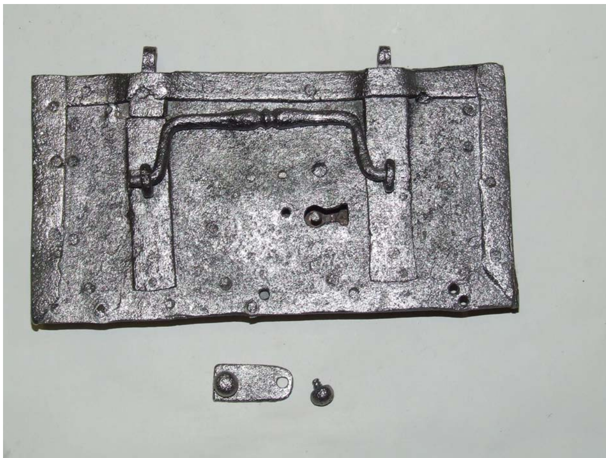
Obr. 18. Pohledová strana vnější - Zakonzervování dílu A minerálním olejem WD 40 a včelím voskem. Včelí vosk byl rozpuštěn v minerálním oleji při teplotě t = 70 stupňů Celsia. Krycí štítek před montáží na základový plech.
