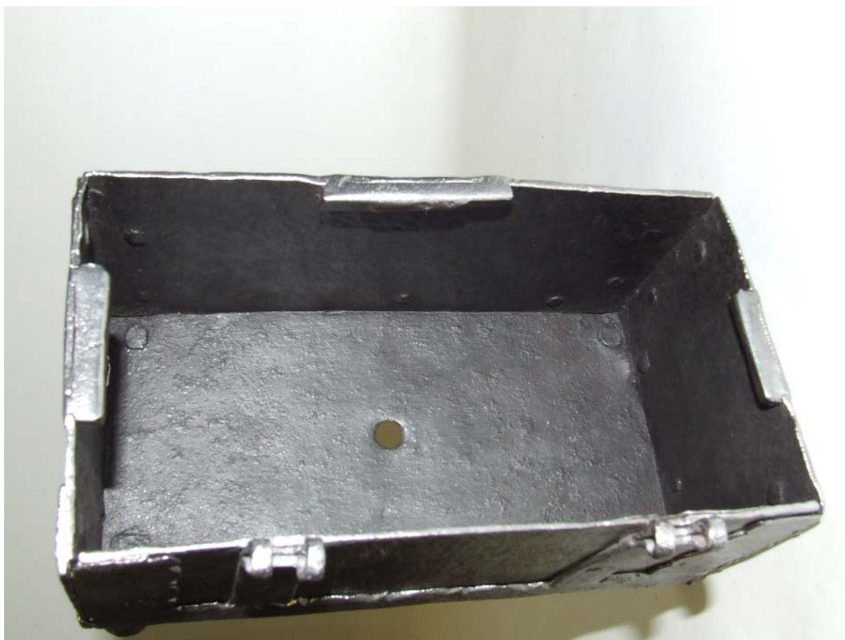
Obr. 44. Původní vnitřní černá povrchová úprava byla po lokálním tanátování roztokem Tanátu A, změkčena lihem a následně rozmělněna ve vnitřním prostoru dílu B. Následně pak byla zakonzervována minerálním olejem WD 40 s včelím voskem.
