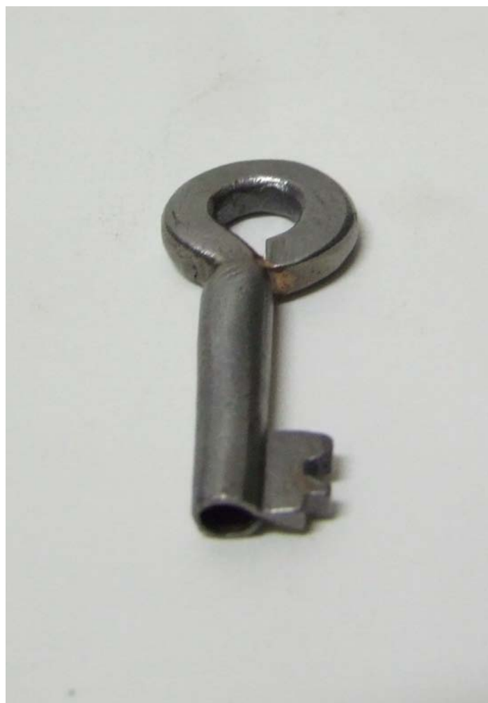
Obr. 26. Replika klíče pro zámkový mechanismus dílu A. Brada klíče je vypilovaná dle otisku ze zámkové zábrany a následně dopasován v mechanice zámku dílu A. Klíč je funkční pro zámkový mechanismus.
