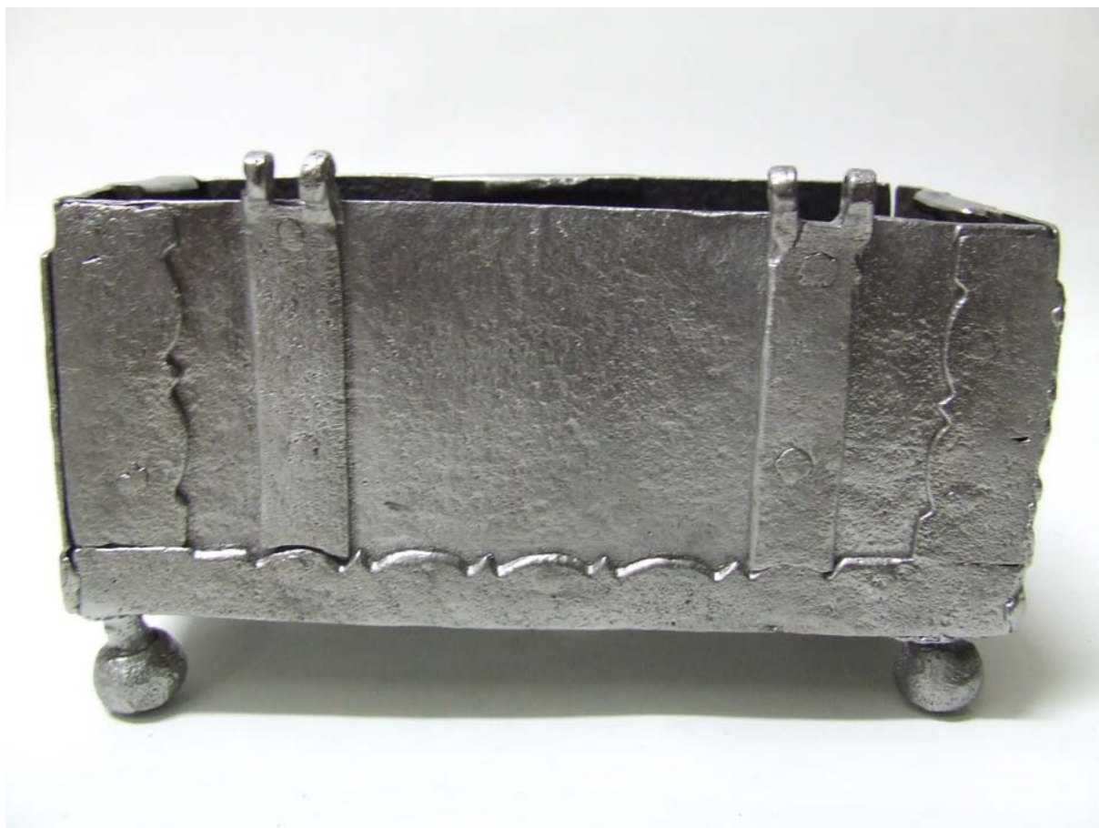
Obr. 46. Pohledová zadní strana - po vysušení celého dílu B od rozpouštědel, byl celý díl B zakonzervován minerálním roztokem oleje WD 40 s včelím voskem. Včelí vosk byl rozpuštěn při teplotě t = 70 stupňů Celsia. Následně zatřen flanelem od přebytků roztoku WD 40 a včelího vosku.
