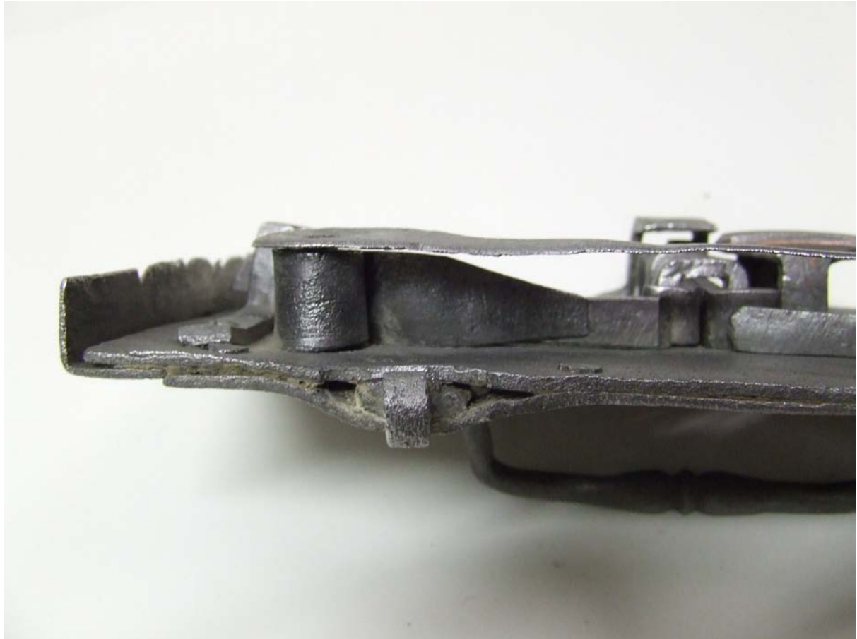
Obr. 14. V místech spojů se opakovaly oplachy technickým benzínem s užitím ultrazvuku a následným mechanickým čištěním. Postupné snižování kyselosti dílu A se zjišťovalo pomocí lakmusového papírku.
