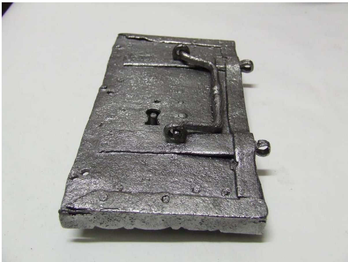
Obr. 19. Boční pohled – pravý - díl A po konzervaci minerální olejem WD 40 s včelím voskem. Praskliny a deformace a jiné vady nebyly opravovány. Nemají vliv na celkovou pevnost dílu A.
