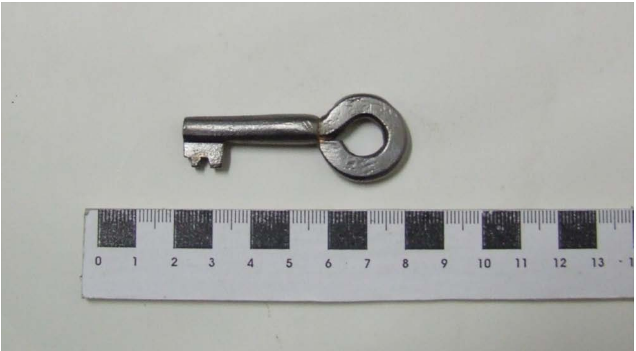
Obr. 25. Replika klíče pro zámkový mechanismus dílu A.
